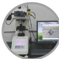
数显显微维氏硬度计 Vickers Hardness Tester 测试维氏硬度 To test Vickers hardness
